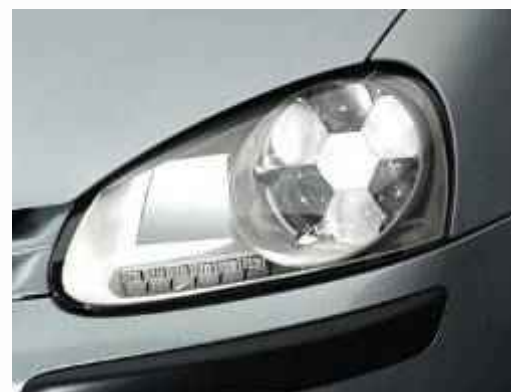
Možný vzhled budoucích AFS světlometů využívajících LED technologie
